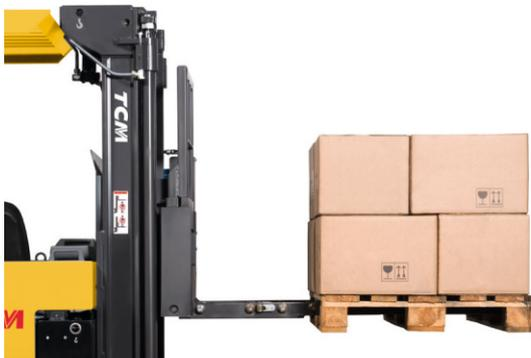
Для моделей SRO и SSO предусмотрена возможность комплектации телескопическими вилами, это модели SRT и SST. Они могут работать со стеллажами с поддонами двойной глубины, чтобы сократить ширину прохода еще больше, или загружать и разгружать транспорт с одной стороны. В некоторых случаях SRT и SST могут заменить небольшой ричтрак.
